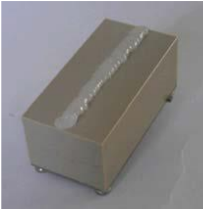
Abbildung 10 Aufbringen des Ultraschall-Kopplungsmittels
