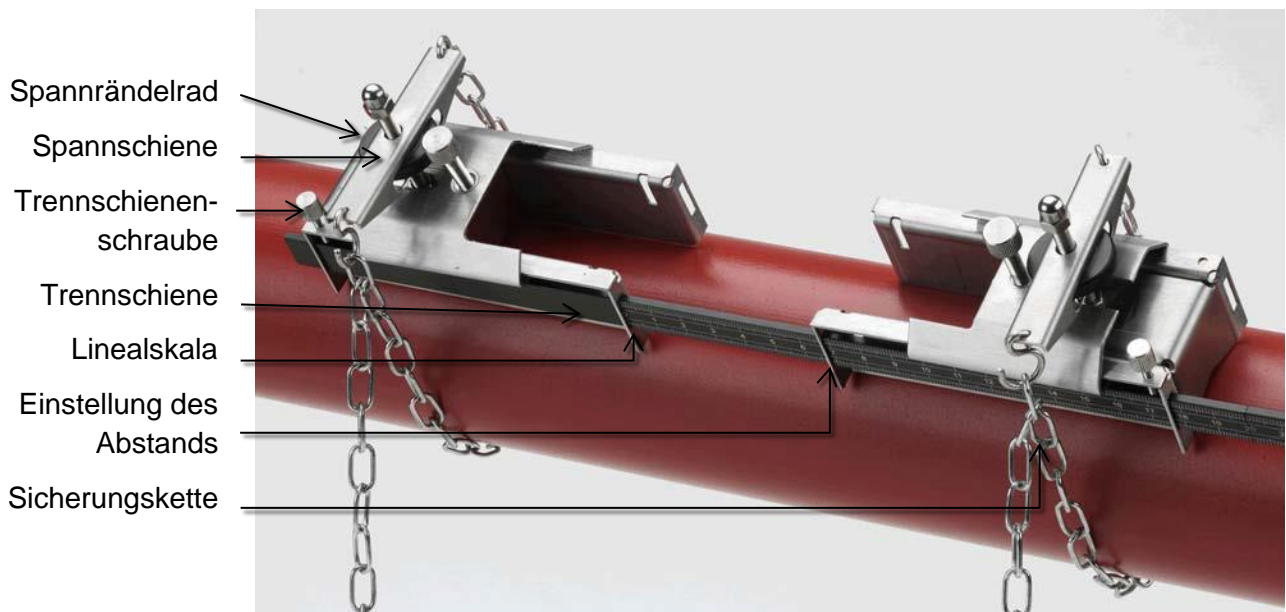
Abbildung 9 Führungsschienenbaugruppe (Reflexmodus)
