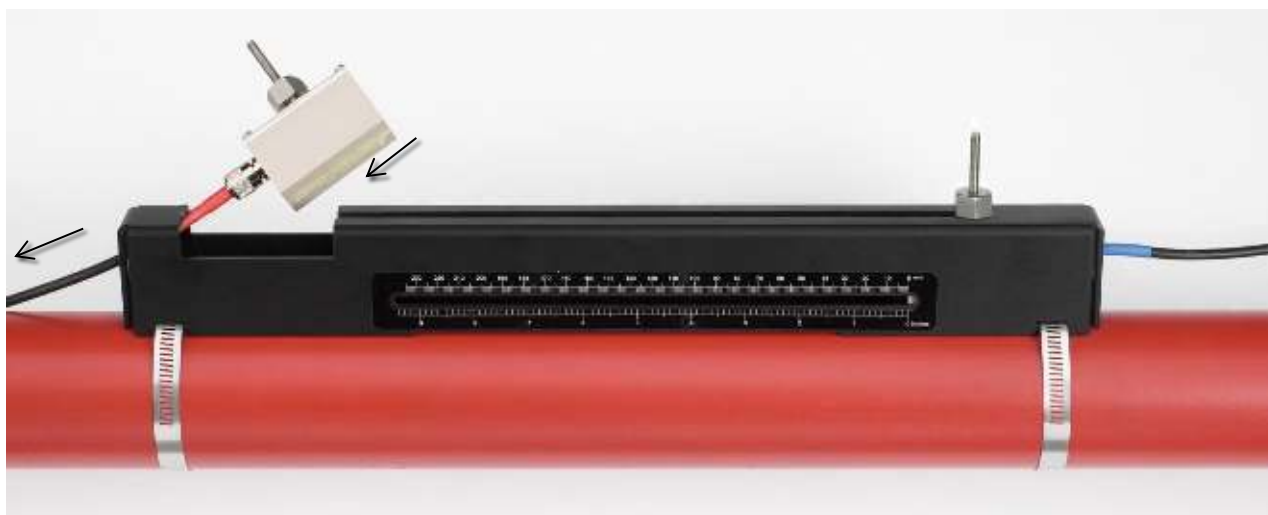
Abbildung 15 Installation des vorgelagerten Messwandlers (rot)
