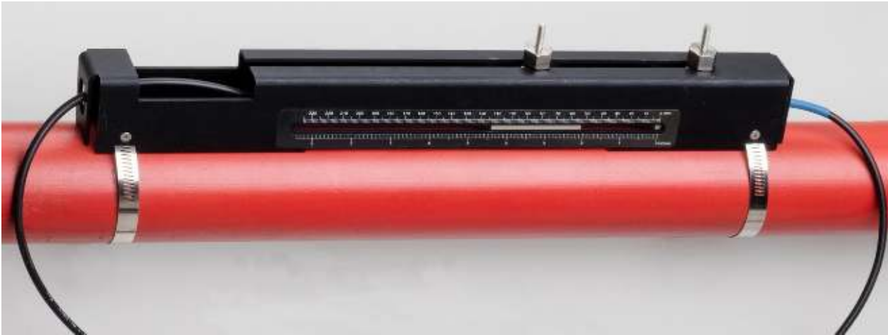
Abbildung 17 Absenken der Messwandler auf das Rohr
